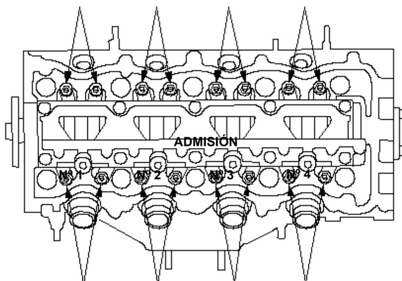
5. Introduzca la galga de comprobación (A) entre el tonillo de ajuste y el extremo del vástago de la válvula del cilindro N° 1, y desplácela hacia delante y hacia atrás; debe notar un cierto rozamiento.
