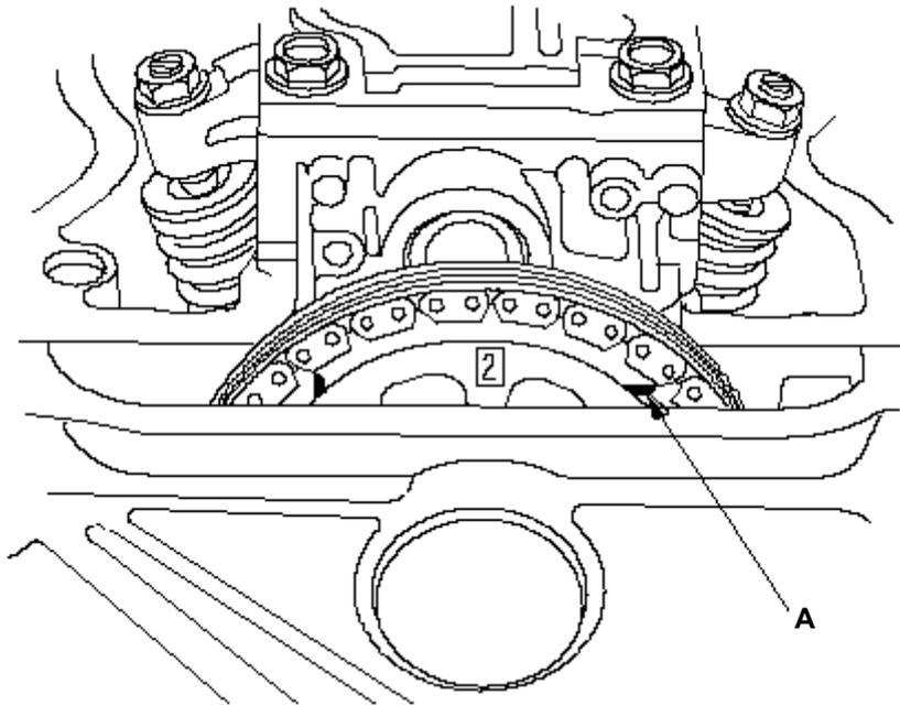
14. Compruebe, y si es necesario ajuste, el reglaje de válvulas en el cilindro N° 2.
