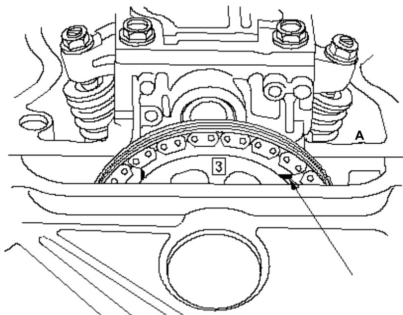
10. Compruebe, y si es necesario ajuste, el reglaje de válvulas en el cilindro N° 3.
