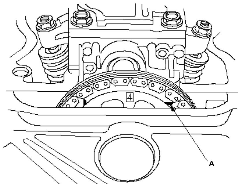
12. Compruebe, y si es necesario ajuste, el reglaje de válvulas en el cilindro N° 4.
